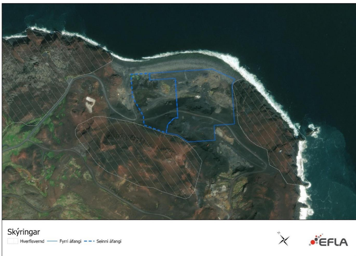
MYND 3.4 Staðsetning framkvæmdarsvæðis með tilliti til hverfisverndaðra svæða. Við hönnun lóðar var áhersla lögð á að fyrirhugað framkvæmdarsvæði myndi ekki fara inn fyrir svæði sem njóta hverfisverndar. (mynd: EFLA)
